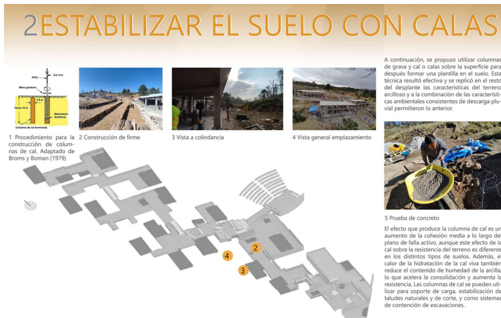
Imagen 3. Estabilización del suelo con calas. Fuente: Neve, L.
